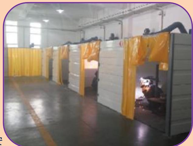
改善后，焊接车间制作了9个独立的焊接工位，每个工位内放置焊机、除尘设备，并安装了摄像头，能够满足日常的教学场地要求，很好的提高了教学效果。
